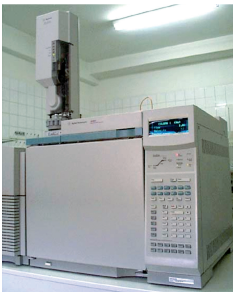
Confirmación: Cromatógrafo de Gases / Masas: Agilent Technologies 6890 N La confirmación inequívoca de aquellos resultados positivos a alguna droga de abuso mediante el enzimoimmunoensayo se lleva a cabo mediante la técnica de cromatografía de gases asociada a espectrometría de masas. Adicionalmente, esta técnica también se emplea en la determinación de drogas a partir de soportes diferentes del suero u orina, como el cabello.
