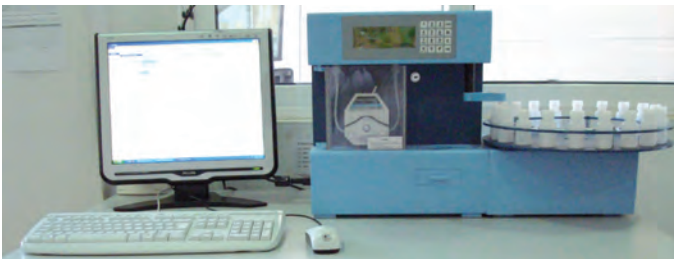
Imagen cedida por DDM. Equipo de dispensación acoplado a programa informático
